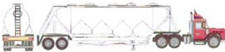
Cisterna para cargas secas a granel o descargas al vacío
